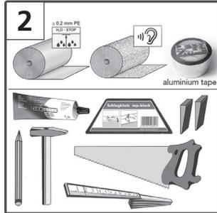
**Vorbereitung:** Bitte lagern Sie die Pakete 48 Stunden vor der Verlegung unter gleichen klimatischen Bedingungen, wie bei der Verlegung [1]. Wichtige Voraussetzung für den Einbau und eine lange Werterhaltung des Laminatbodens ist ein Raumklima mit 15 – 30°C und einer relativen Luftfeuchtigkeit von 40 – 70%.
